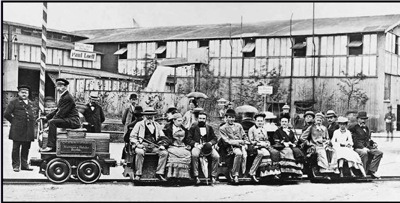
Erste elektrische Bahn (Siemens), vorgestellt bei einer Gewerbeausstellung am Lehrter Bahnhof (1879)
